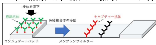
図 1 免疫クロマトグラフィの基本構造
